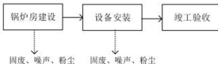
图 2-3 施工期工艺流程及产污环节图
